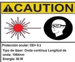
La luz láser de longitud de onda de 1064 nm emitida por este sistema láser es invisible y puede dañar el ojo humano. Es imprescindible llevar siempre gafas de protección láser adecuadas durante el funcionamiento.
